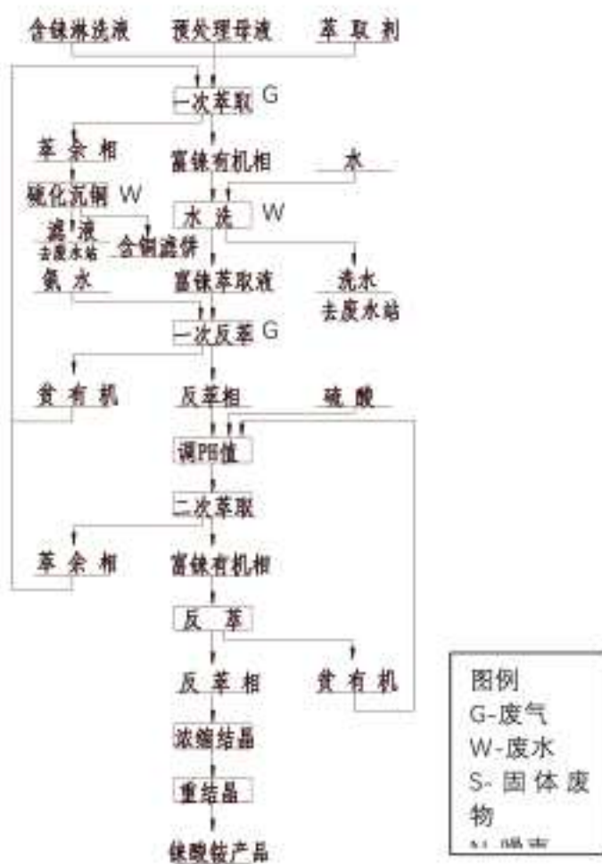
图 3.3-1 (2) 铼酸铵生产工艺流程及排污节点图
